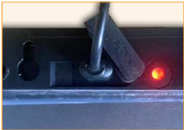
Detalle de Carga mediante el puerto USB-C
